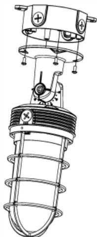
1. Ce luminaire peut être installé directement sur une surface plane ou en suspension avec un raccord de conduit de 1/2 pouce. Les raccordements peuvent être effectués à l'intérieur du boîtier du luminaire. Pour accéder au boîtier du luminaire, retirer la plaque arrière du luminaire en enlevant les 4 vis en acier inoxydable no 8 -32 sur la plaque arrière.
